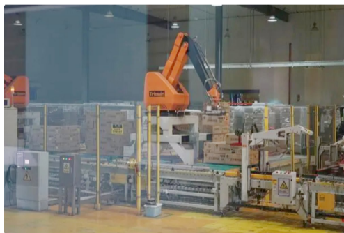
慈溪正大蛋业有限公司的分级车间内,机械手正将包装好的鸡蛋整齐地码垛。
