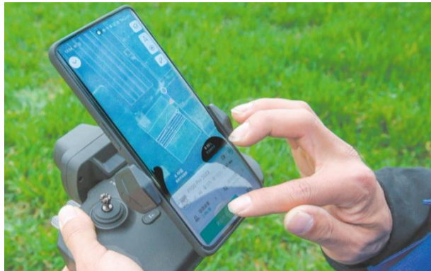
植保机飞手在手机上规划飞行线路,安装有北斗导航系统的无人机将进行全自动作业。
