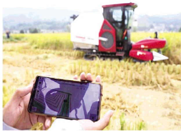
工作人员在用手机监控无人收割机运行情况。吴昌连 摄
